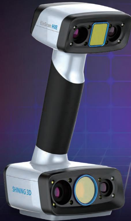
EinScan HX2は、従来のEinScanシリーズに搭載されていたLED光源と、EinScanシリーズ初となる青色レーザー光源の両方を搭載したことで、自動車のような大きな対象物もスキャンすることが可能となりました。大きな対象物も高い精度でスキャンすることができるため、リバースエンジニアリングなど、現物のデータを活用した製造業のデジタルトランスフォーメーションにも活用可能です。
